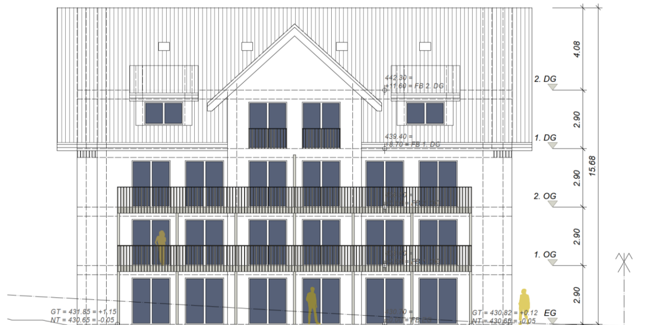
Abbildung 24: Ausschnitt Richtprojekt: Fassadengestaltung Nord-West-Fassade
